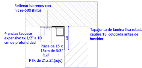
D03 Detalle panel acústico Panel acústico auditorio
